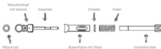
Abbildung 1: Bestandteile der Drehmoment Ratsche im zerlegten Zustand
