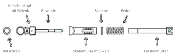
Abbildung 1: Bestandteile der Drehmoment Ratsche im zerlegten Zustand
